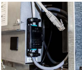
KESKUSHÄLYTYSLIITÄNTÄ RJ45 KAAPELI KYTKETTYNÄ
