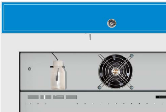
50 ml pullo lämpötila-anturille kaapin sisällä
