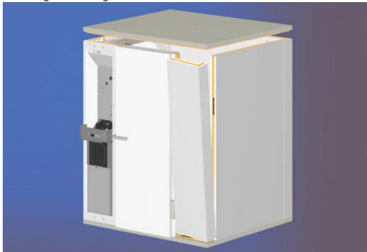
Tek. 10: Montage van het hoekelement en de plafondelementen
