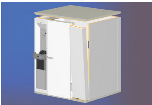
Bild 10. Der Aufbau der Dach- und Eckelemente
