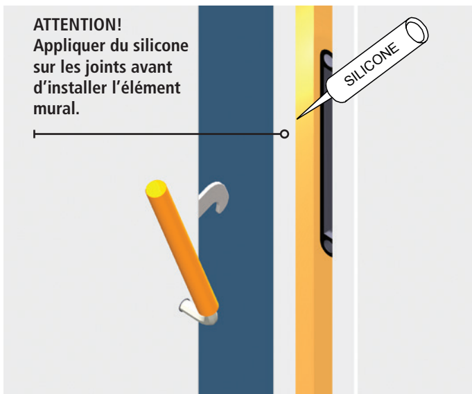
Photo 4. Joint à baïonnette (crochet)
