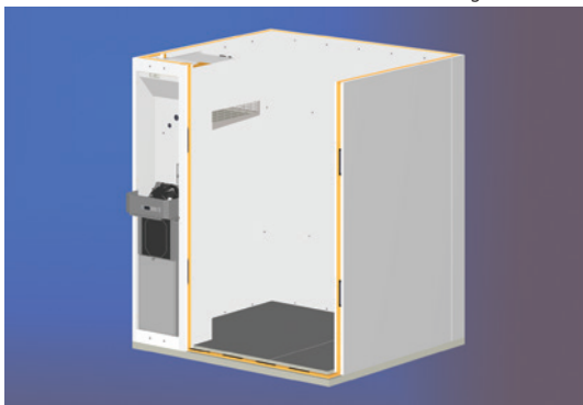
Bild 9. Montering av väggpaneler
