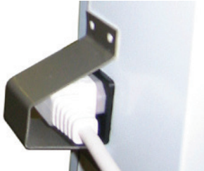
Fig. 13. Karmvarmestik og -kabel med beskyttelsesdæklade.
