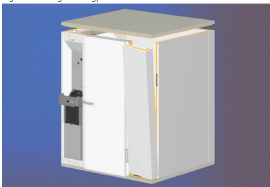
Fig. 10. Montage af hjørne-, dør- og loftspanel
