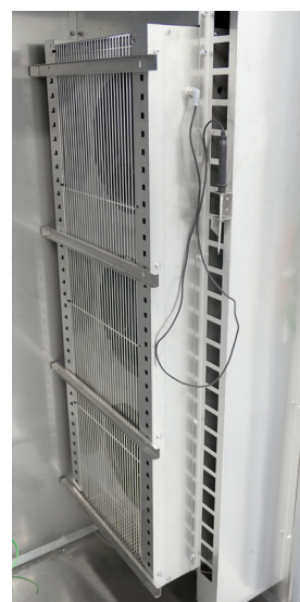
Sisällä on varrellinen tuotelämpötila-anturi, jonka avulla voidaan seurata kalusteisiin laitettujen tuotteiden jäähtymistä.
